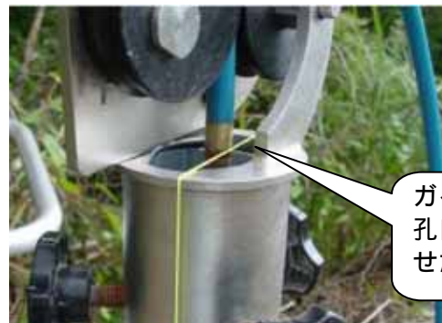
ケーブルのマーカー位置とホルダの位置関係(応用地質(株)製)
