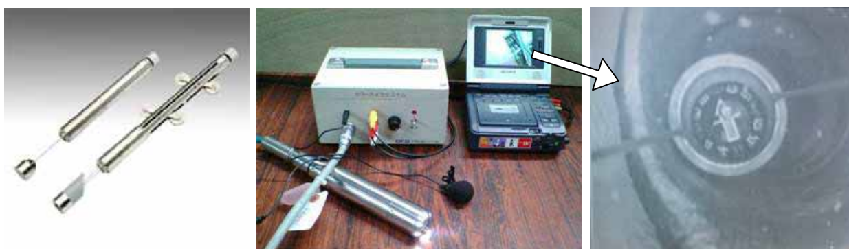
孔内カメラと開口亀裂の例
