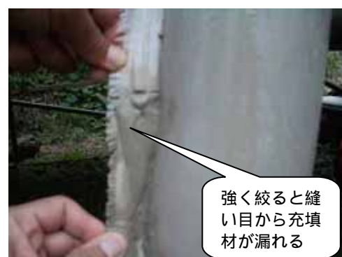
充填材の注入テスト(ジオテキスタイルパッカーの例)
